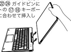
2 タブレットをしっかり和押し付けて、確実に固定されたことを確認してください。
